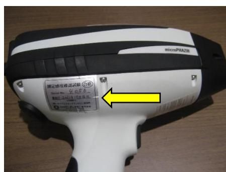
図 4. 測定感度確認試験合格証貼付例
