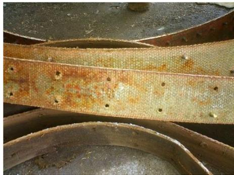
図 3.11 ウィンドラスのブレーキライニング
