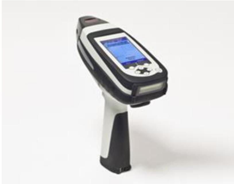
図 1. アスベストアナライザー概観
