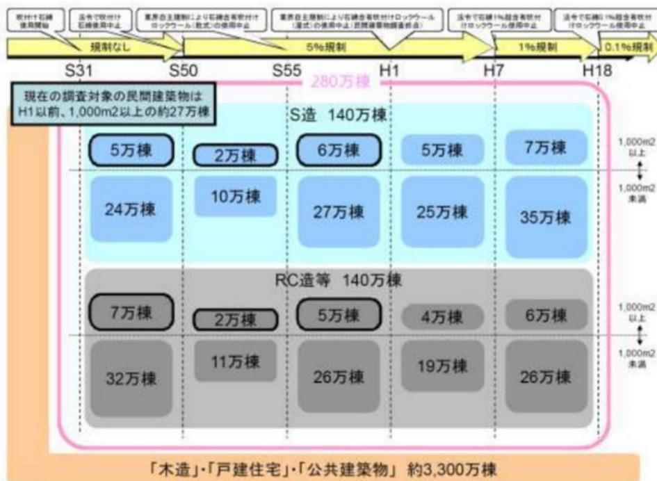
図 1.4 S造・RC造等の残存建築数
