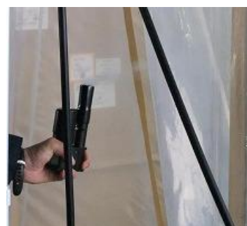
参考図 4.9 セキュリティーゾーンの入口の気流方向の確認
