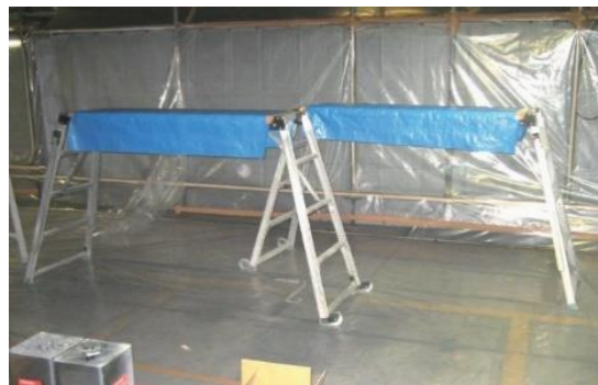
参考図3.33 可搬式作業台の例
