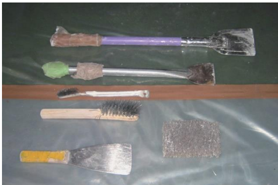
参考図 3.34 除去作業用の手工具の例
