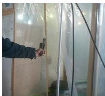
参考図 4.9 セキュリティーゾーンの入口の気流方向の確認
