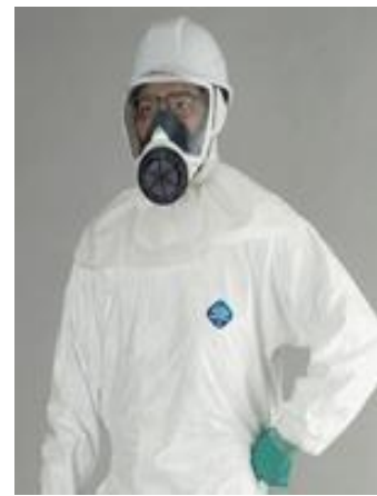
図5.2.4 半面形電動ファン付き呼吸 用保護具(専用フード併用) の例
