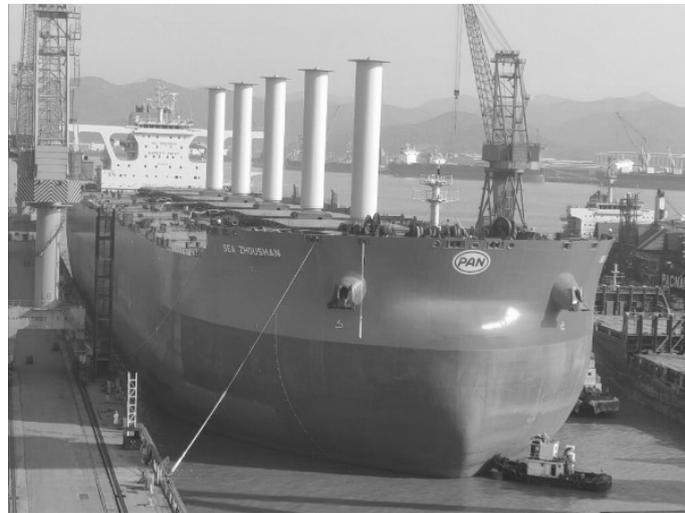
図 44 Norsepower ローターセイルを搭載した 325,000DWT 型鉱石運搬船
