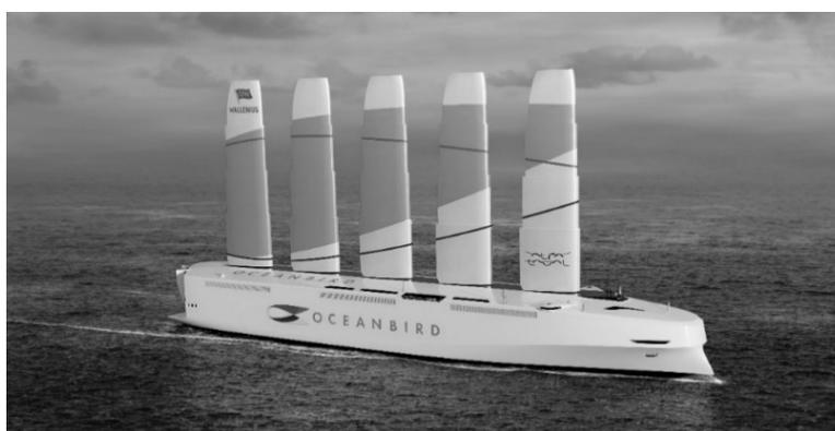
図 34 AlfaWall の風力支援推進システム「Oceanbird」
