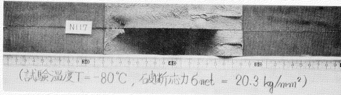
写真4.6 ディープノッチ試験片破面状況
