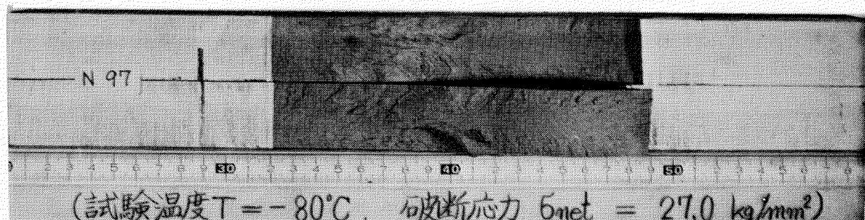
写真 4.10 デイブノツチ試験片破面状況
