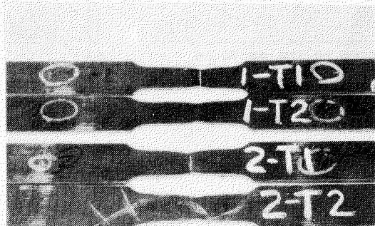
写真1 引張試験後の外観
