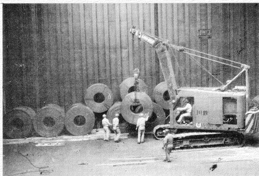
＜写真3.1.7＞：モービルクレーンによる積荷状況。22<sup>t</sup> SWL のキャタピラ付である。
