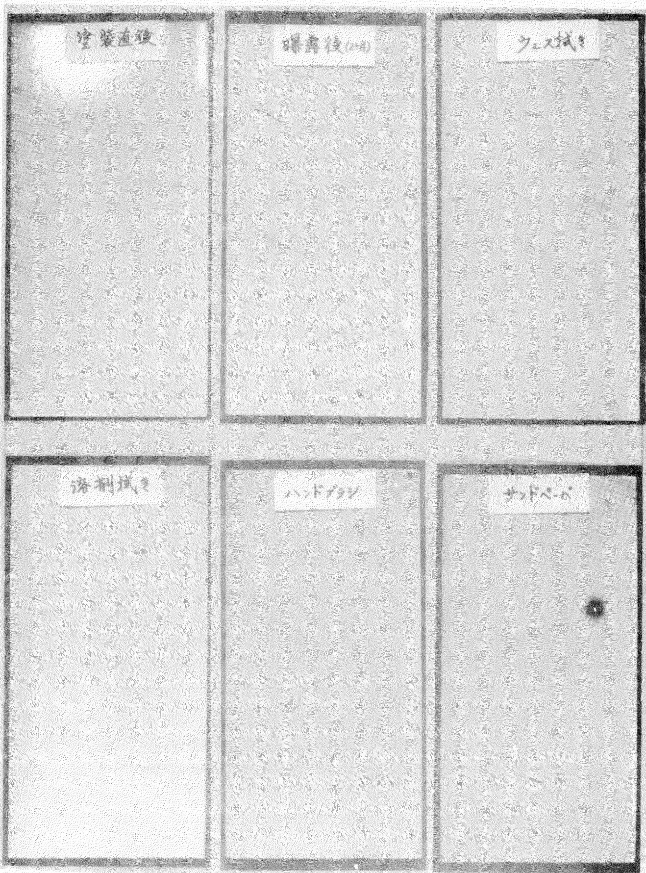
図 4.4.4.6 下地処理別塗膜表面の変化
