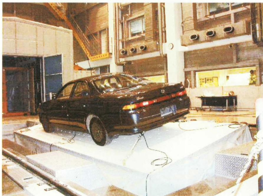
写真 3. 大型輸送環境再現装置による自動車傾斜試験
