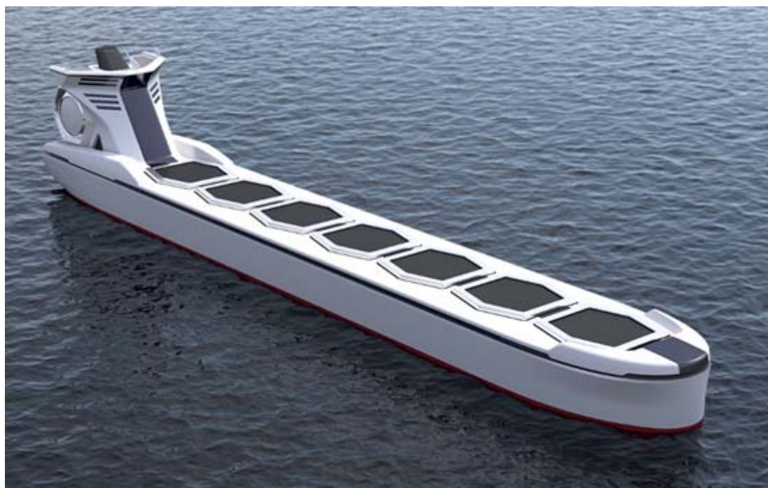
図 付録 3.1-5 : 80,000DWT 級バルクキャリアの外観イメージ(水素燃料船)
