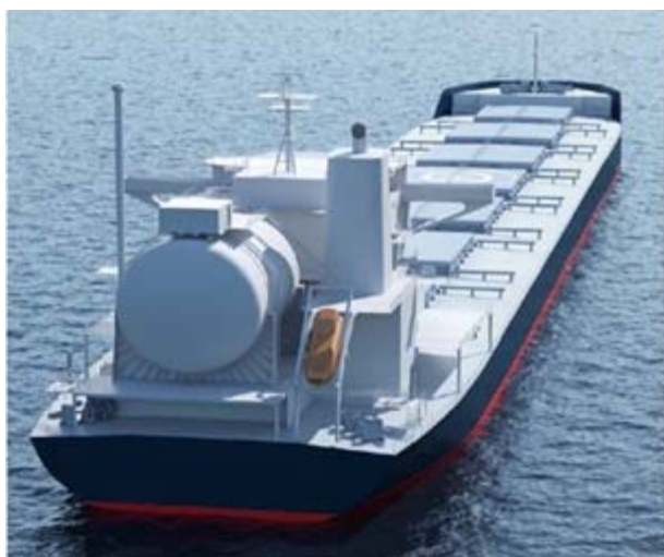
図 4.4.2-2: アンモニア燃料関連機器配置イメージ
